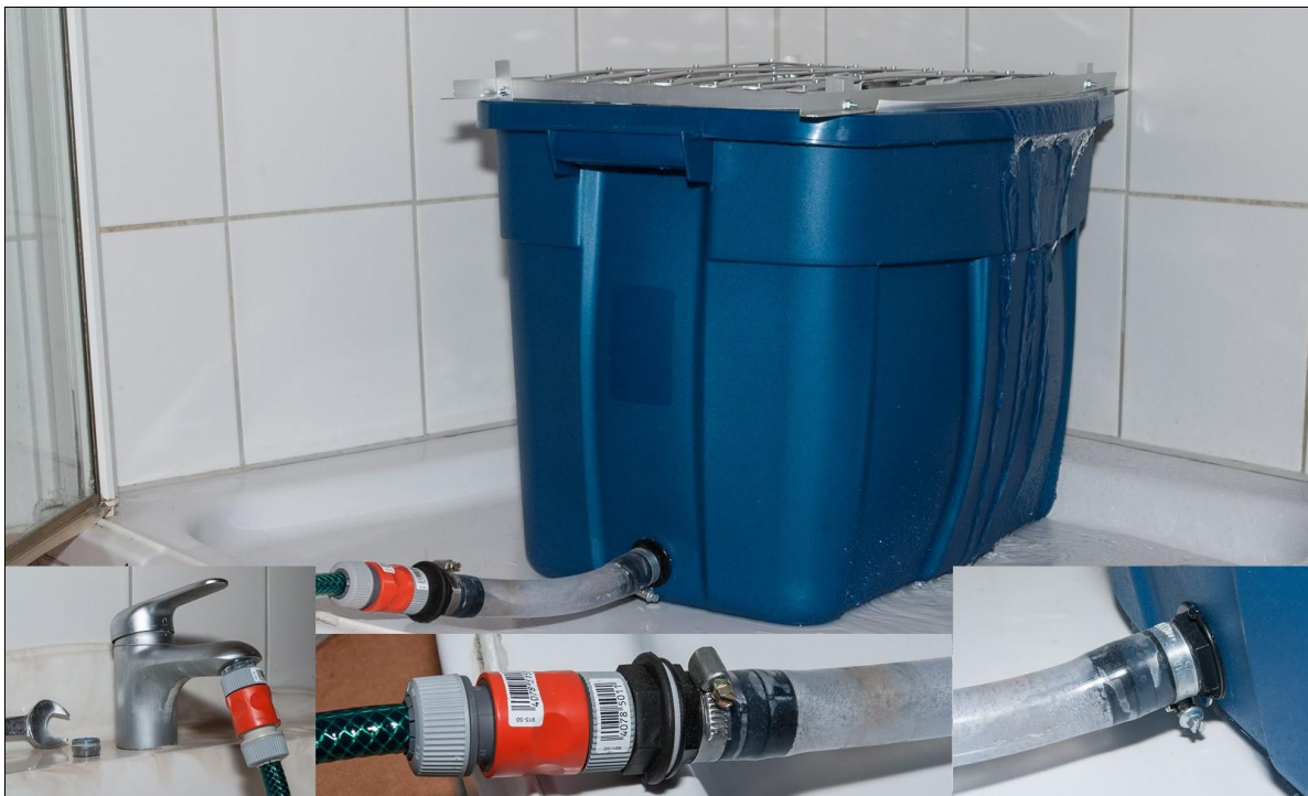
Abbildung 3: Hier sehen Sie den Barytwascher mit allen außen befindlichen Schlauchanschlüssen, die nur aus standardisierten Schraub- und Steckverbindungen bestehen. Bitte beachten Sie dabei die Schlauchklemmen, auf deren Bedeutung in der Beschreibung gesondert eingegangen wurde.
