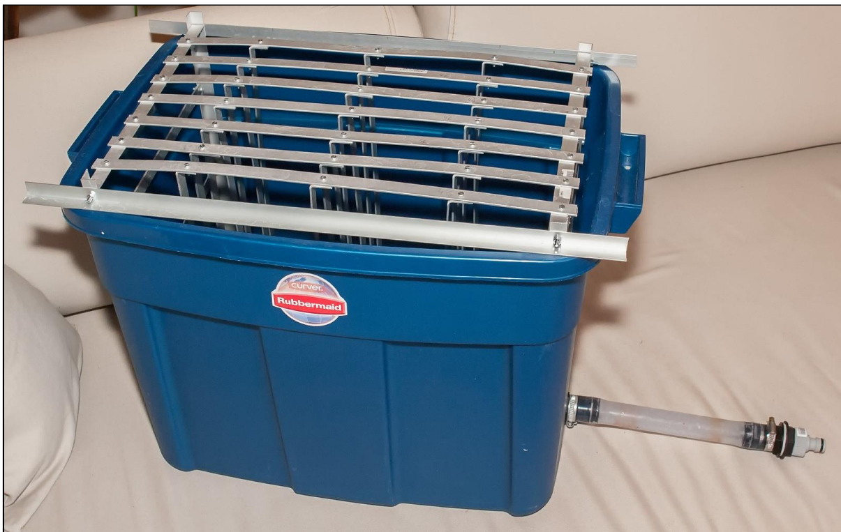
Abbildung 2: Der Korpus des fertigen Barytwaschers, bestückt mit dem Wässerungskorb und bereit zum Anschluss an einen Wasserschlauch.
