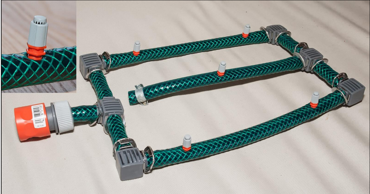
Abbildung 4: Hier erkennen Sie die einzelnen Schlauchstücke, die mit Hilfe der Micro-Drip-Kupplungsstücke einfach zusammengesteckt wurden: 4 L-Kupplungsstücke und 2 T-Kupplungsstücke sind dazu erforderlich. Ebenso können Sie hier im Detail eine der 360°-Sprühdüsen erkennen, die einfach in den Schlauch eingeschraubt werden. Selbstverständlich können Sie auch weitere Sprühdüsen ganz nach Bedarf einschrauben.
