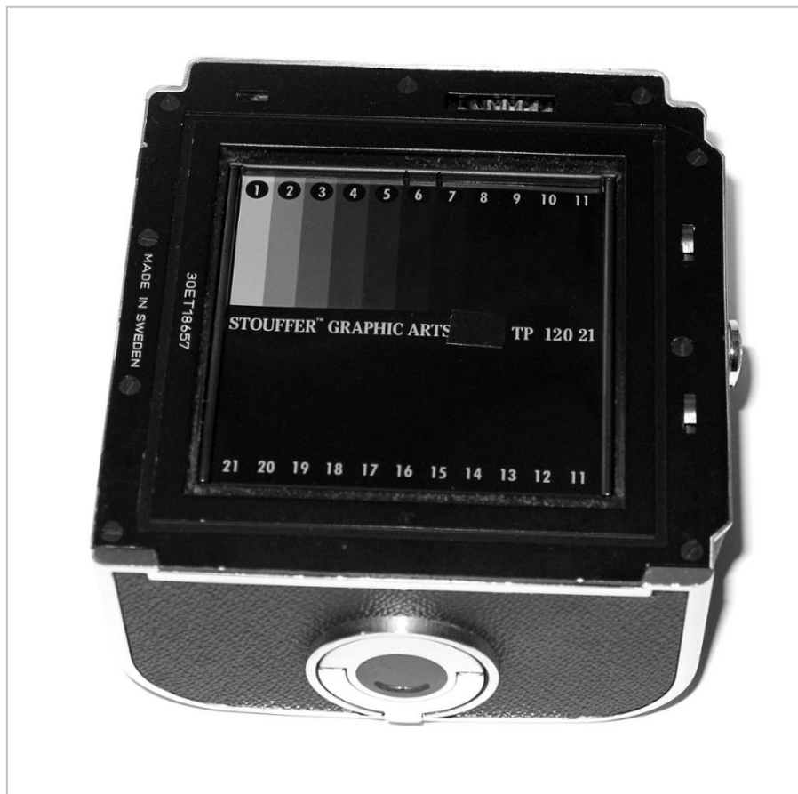
Abbildung 3: So sieht das für die Testbelichtung vorbereitete Magazin aus. Der Schieber ist für Demonstrationszwecke hier gezogen.
