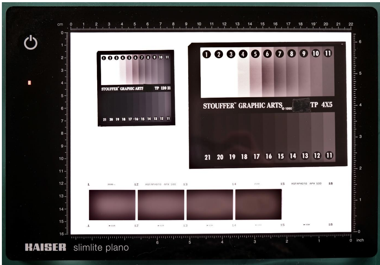
Abbildung 2: Leuchtplatte mit Testnegativen für Roll- und Planfilm und KB-Filmstreifen
