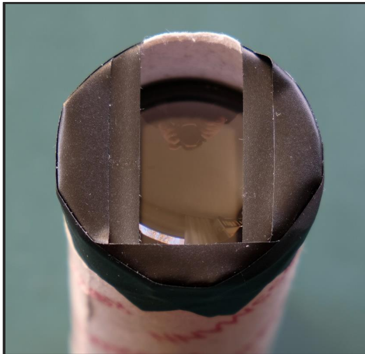
Abbildung 6: Zusätzlicher Schutz vor Streulicht
